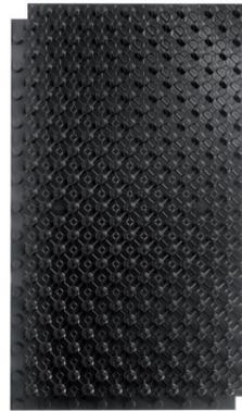
Panel aislante CABEL con tetones, en poliestireno expandido, autoextinguible (Euroclase E), de 10, 18 y 25mm de espesor útil, densidades de 30 y 25 kg/m<sup>3</sup> respectivamente. Provisto de tetones moldeados para la fijación del tubo con separaciones en múltiplos de 50 mm, y perfiles perimetrales machihembrados para el montaje; con lámina de poliestireno termoformado, color negro, de 600 µm de espesor.
