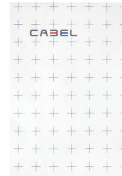
Panel aislante CABEL liso, fabricado en polietileno expandido (EPS), autoextinguible (Euroclase E) de 25mm de espesor, densidad de 20 kg/m<sup>3</sup>, cubierto por una lámina superficial de polietileno tereftalato (PET), de 0,25mm de espesor, provisto de solapas para unión entre paneles y cuadrícula de guía serigrafiada.
