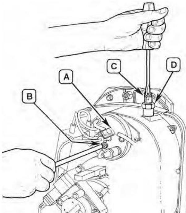
fig. 28 - Regulación del quemador
