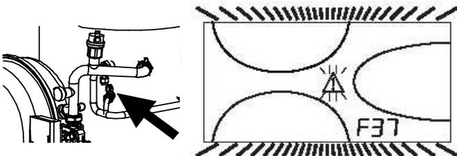
fig. 16 - Anomalía presión insuficiente en la instalación
