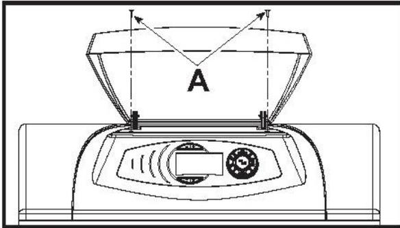
fig. 24 - Acceso a la regleta de conexiones
