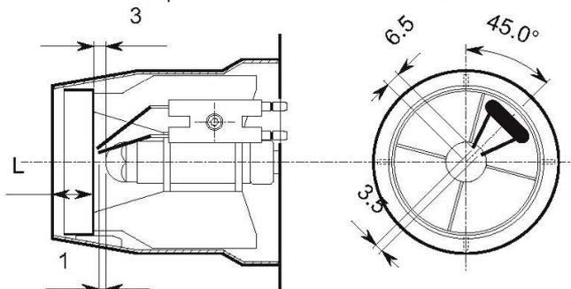
fig. 29 - Posición de los electrodos y del deflector
