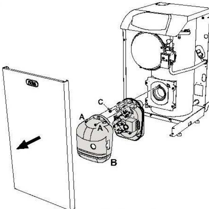
fig. 32 - Desmontaje del quemador
