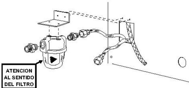
fig. 20 - Instalación del filtro del combustible
