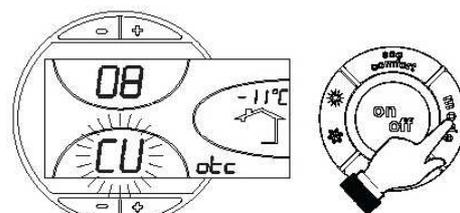
fig. 13 - Desplazamiento paralelo de las curvas
