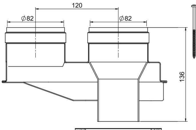
fig. 8 - Accesorio inicial para conductos separados cód. 010031X0 / 4740
