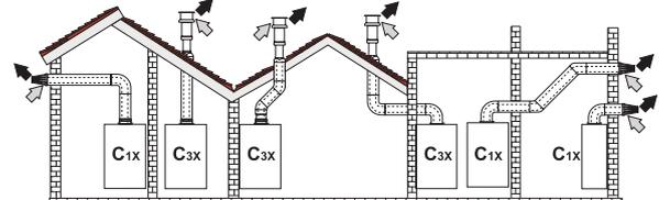
fig. 5 - Ejemplos de conexión con tubos coaxiales (→ = aire / ← = humos)
