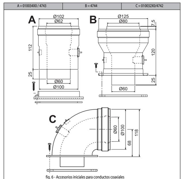
fig. 6 - Accesorios iniciales para conductos coaxiales
