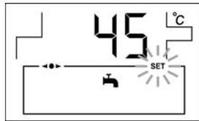
Consigna de temperatura de A.C.S. seleccionada mediante el selector táctil correspondiente **(23)**.
