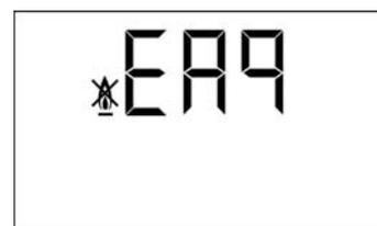
Se produce por cualquier anomalía que pudiera existir en el quemador **(4)** o en la instalación de combustible. Para desbloquear, pulsar el pulsador luminoso que se enciende en el quemador.
