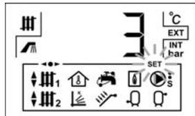
Contraste de la pantalla deseado, ajustado mediante selector táctil de la parte derecha del display **(23)**.
