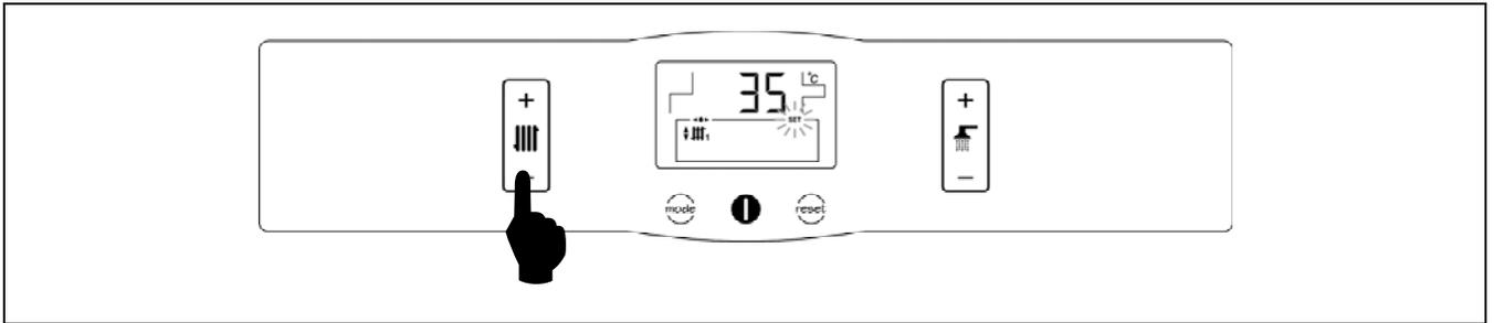
Cuando la caldera es instalada con el Kit opcional de Suelo Radiante SRFM2/EV, la selección de la temperatura deseada de funcionamiento de de ida de la instalación se realiza mediante el selector táctil indicado en la figura. Para seleccionar la temperatura deseada tocar en los símbolos "+" o "-" para incrementar o disminuir el valor de la temperatura, respectivamente. Una vez seleccionada la temperatura, en unos pocos segundos la pantalla regresará a la situación de reposo.
