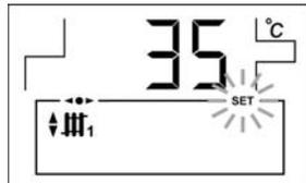
Consigna de temperatura de ida de la instalación de Suelo Radiante seleccionada mediante el selector táctil correspondiente **(19)**.
