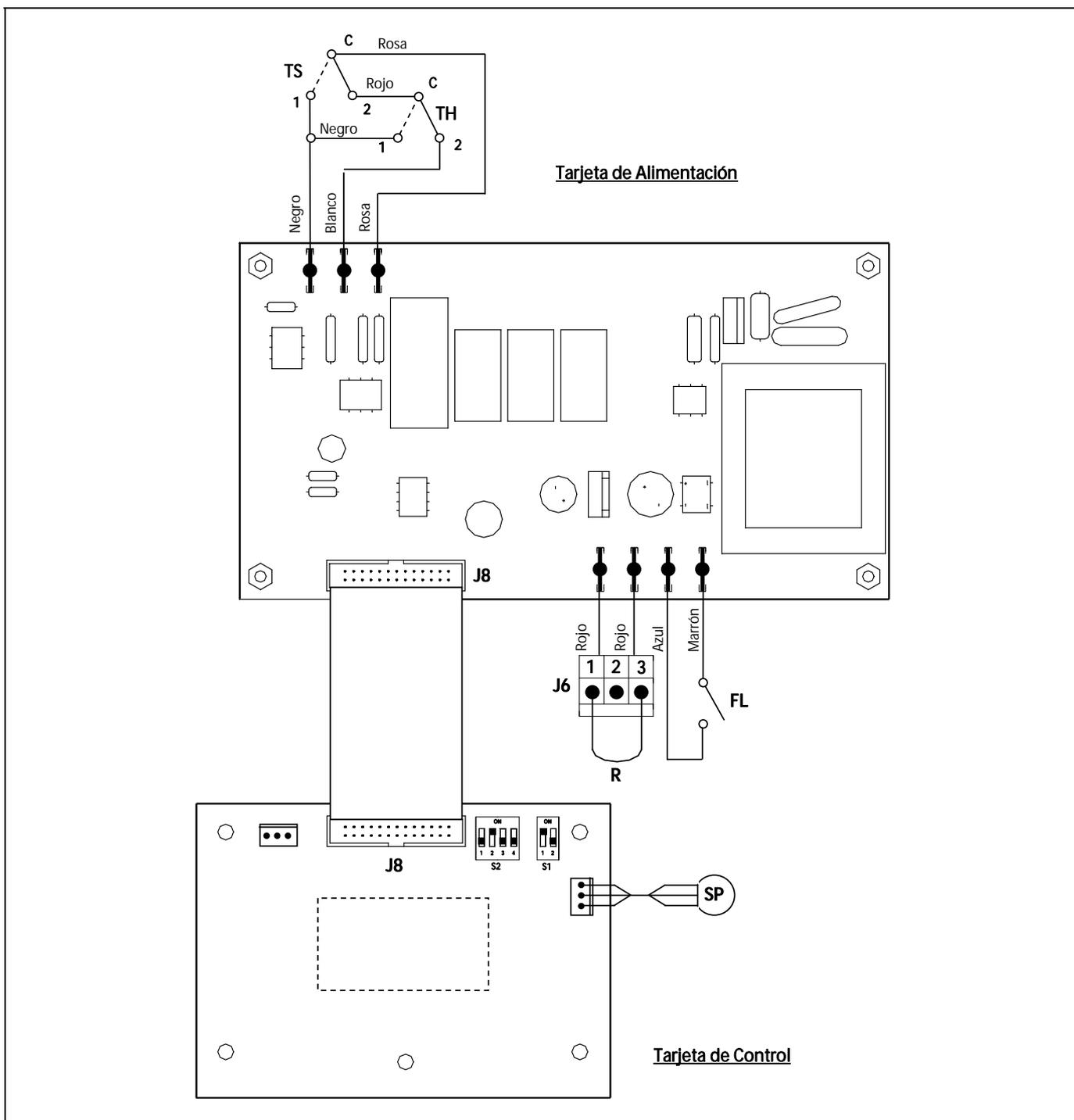
**TS:** Termostato de Seguridad.
