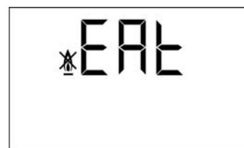
Se producirá siempre que la caldera sobrepase los 110 °C de temperatura. Para desbloquear, se deberá esperar a que la temperatura de caldera baje de 100 °C y se deberá pulsar el botón incorporado en el termostato de seguridad, situado en el interior de la caldera en la parte inferior del cajón eléctrico, después de haber soltado primeramente el tapón que tapa este botón.
