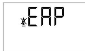
Se produce cuando la presión de la caldera baja por debajo de 0,5 bar, evitando que ésta funcione cuando se vacía de agua la instalación, bien por tener alguna fuga o por operaciones de mantenimiento. Para desbloquear, se deberá llenar de nuevo la instalación, hasta que en el parámetro de *"presión de la caldera"* del display **(18)** se visualice una presión entre 1 y 1,5 bar.
